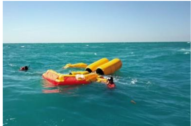
Fig. 1.1.b. Ubicación de los restos del cuerpo básico suspendidos en forma invertida por los flotadores.
