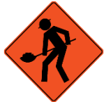
Imagen 5. Representación del señalamiento vertical para protección en zonas de obras viales
