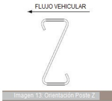
8. La Base de Deslizamiento Ezy-HC se adjunta a la cara del poste y va a descansar en la presilla de posicionamiento fabricada en el poste Z.
