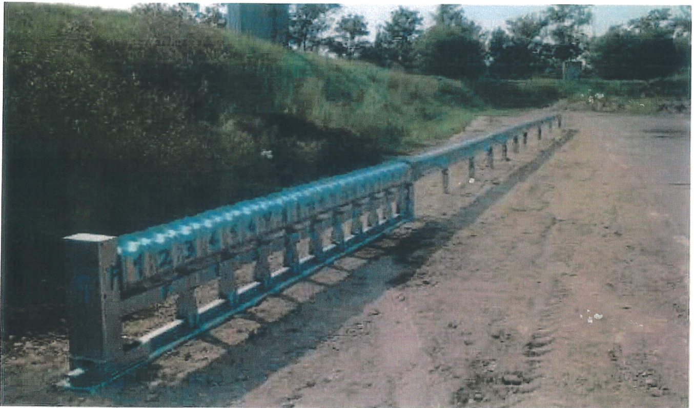
Fig. 2: Prueba de choque del tratamiento de terminal de Ermes MASH TL-3 con conexión a la barrera de seguridad
