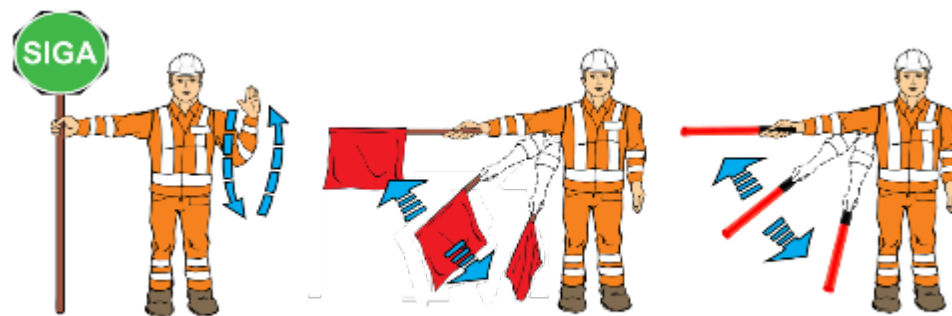
Alertar y disminuir la velocidad del tránsito
