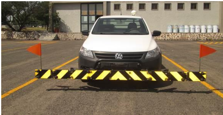
Figura 2. PERFILÓMETRO LÁSER, para la medición del IRI
