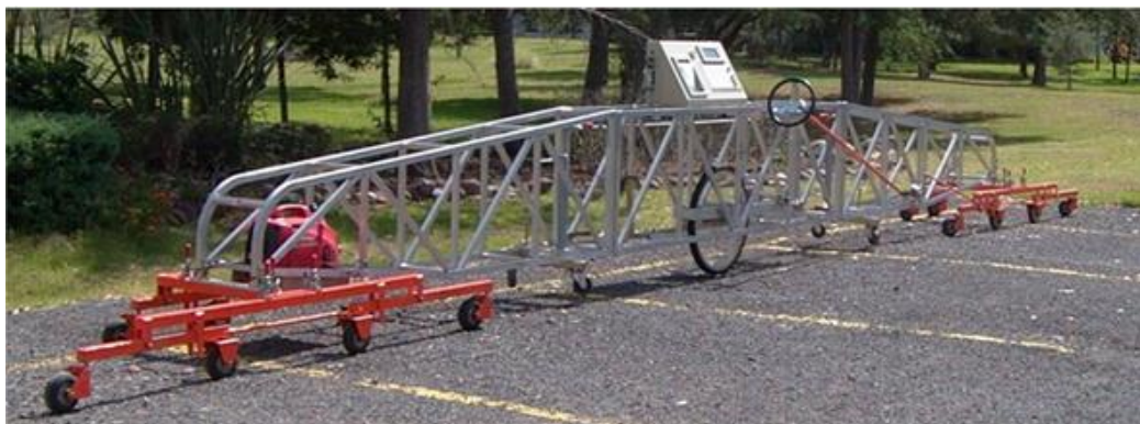
Figura 1. PERFILÓGRAFO TIPO CALIFORNIA, para la medición de IP
