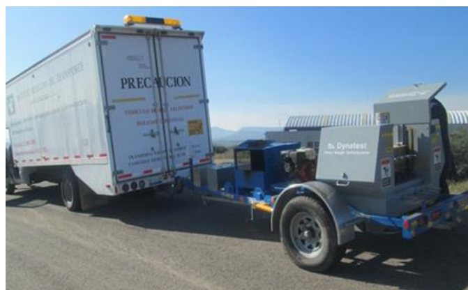
Figura 5. DEFLECTÓMETRO DE IMPACTO DYNATEST (HWD)
