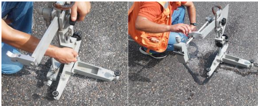
Figura 4. PÉNDULO BRITÁNICO, para mediciones de fricción.
