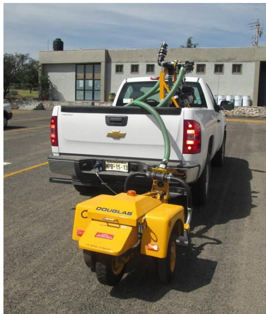
Figura 3. MU-METER MK6, para la medición de fricción
