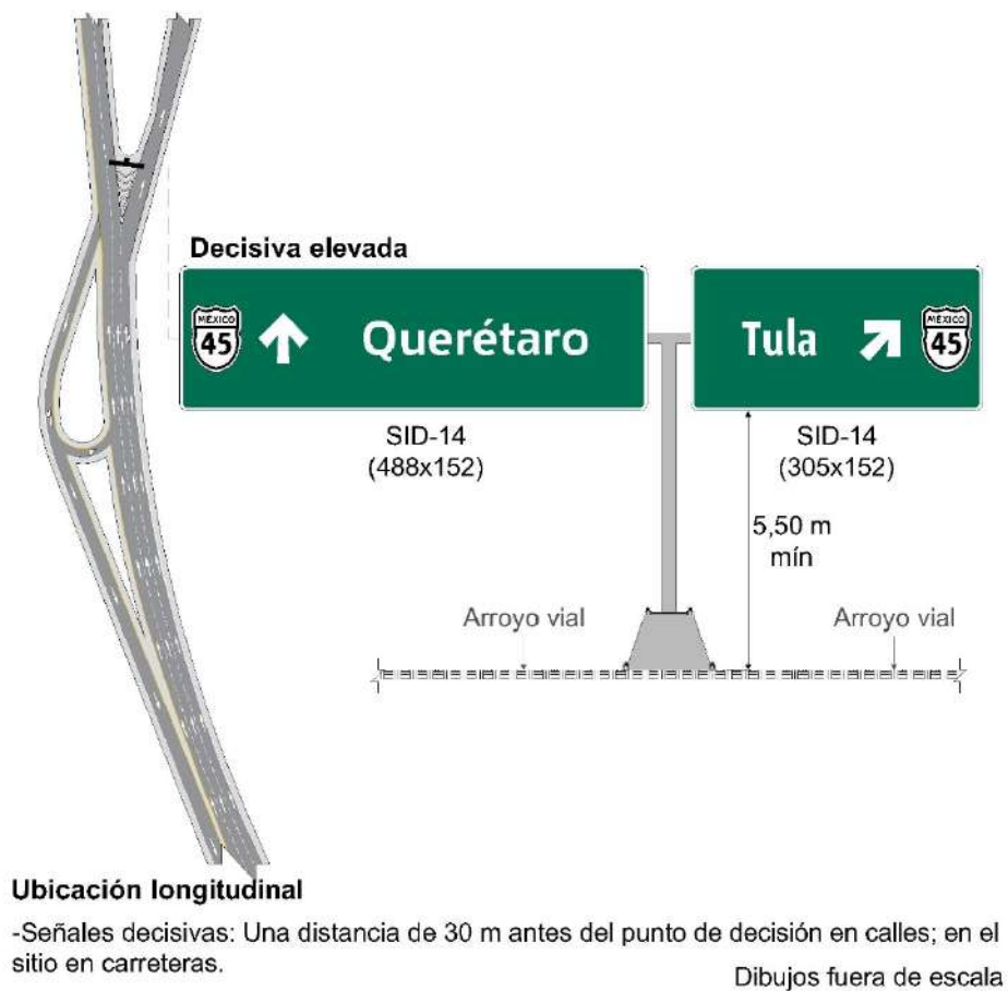
Figura III.4- 33 SID-14 Doble bandera (Acceso a población)
