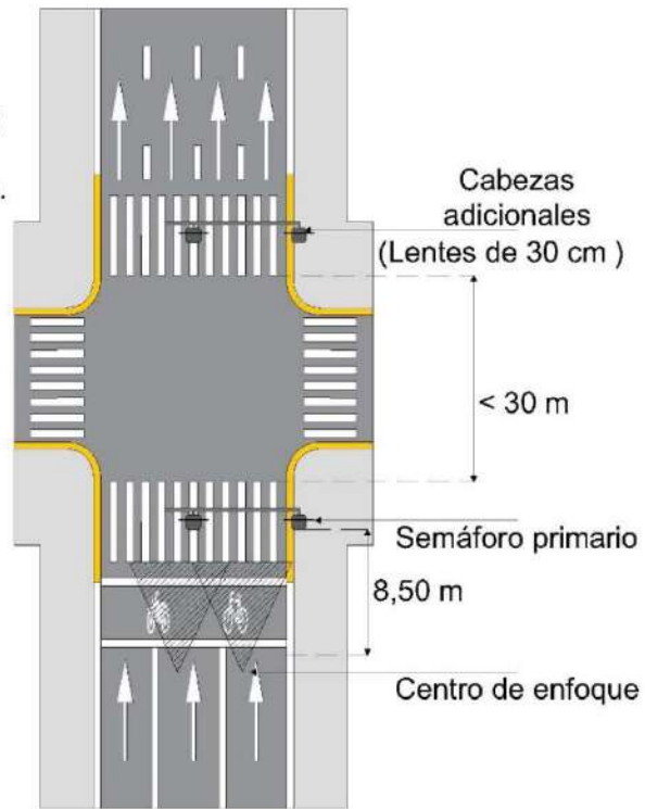
Figura VI.5-35 Ubicación de semáforos en intersección
