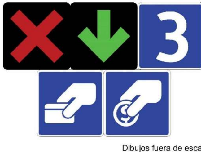
Figura VIII.2-11 Ejemplo de señalización para indicar dos tipos de pago, incluyendo los tableros de las señales luminosas para indicar que la cabina está fuera de servicio "X" o en operación "flecha"
